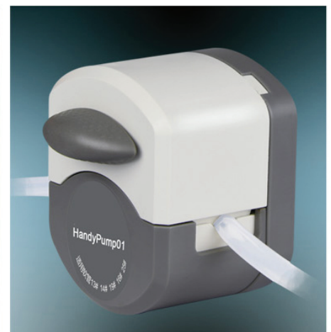
3. 顺时针扳动旋钮 180°, 使压块下压到位, 压紧软管。
